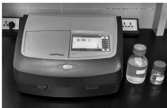
شکل ۱ دستگاه Hach مدل DR6000 برای انجام آنالیزهای مربوط به آب
