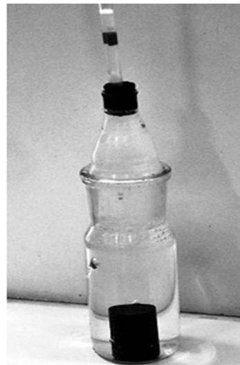
شکل ۲- تصویر مغزه قرار گرفته در سل آشام قبل از انتقال به حمام دماساز
