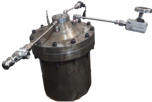
شکل ۱ محفظه تحت فشار جهت شبیه سازی شرایط ته چاهی برای تابش لیزر در شرایط آزمایشگاهی
