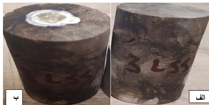
شکل ۲ الف) نمونه کربناته خشک پیش از تابش لیزر و ب) نمونه کربناته خشک پس از تابش لیزر.
