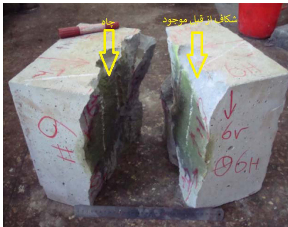
شکل ۱ رفتار گسترش شکافت هیدرولیکی در نمونه آزمایشگاهی در شرایطی که شکافت هیدرولیکی از شکاف طبیعی عبور کرده است (شیب 90^\circ ، زاویه برخورد 60^\circ ) [۱۹].
