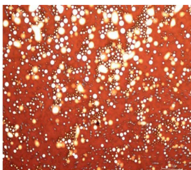
شکل ۵ عکس‌های میکروسکوپی از امولسیون تشکیل شده از زه آب ۲ و نفت A (دور اختلاط ۱۵۰۰ rpm)
