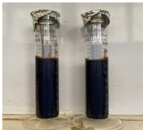
شکل ۹ میزان جدایش فازی نفت B با زه آب الف) اختلاط ۲۰٪ زه آب ۱ و ۸۰٪ نفت ب) اختلاط ۲۰٪ زه آب ۲ و ۸۰٪ نفت (دور اختلاط ۱۵۰۰ rpm)
