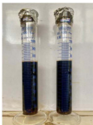
الف) اختلاط ۸۰٪ زه آب ۱ و ۲۰٪ نفت ب) اختلاط ۸۰٪ زه آب ۲ و ۲۰٪ نفت ج) اختلاط ۲۰٪ زه آب ۱ و ۸۰٪ نفت د) اختلاط ۲۰٪ زه آب ۲ و ۸۰٪ نفت
