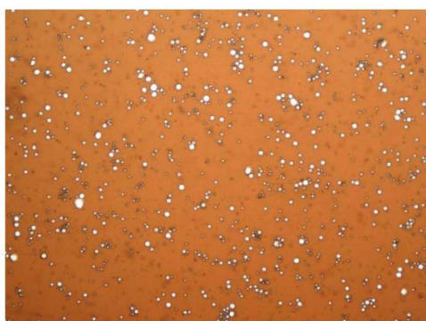
شکل ۶ شکل راست: میزان جدایش فازی نفت A با زه آب (دور اختلاط ۱۵۰۰ rpm) الف) اختلاط ۸۰٪ زه آب ۲ و ۲۰٪ نفت A ب) اختلاط ۲۰٪ زه آب ۱ و ۸۰٪ نفت A. شکل چپ: تصویر میکروسکوپی گرفته شده از امولسیون ۲۰٪ زه آب ۱ و ۸۰٪ نفت A
