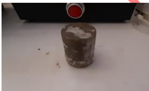
شکل ۲۱: نمونه مغزه پس از سیلابزنی با فیلترات گل حفاری بهبود یافته
