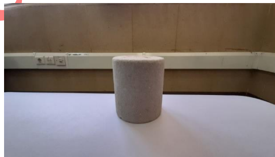
شکل ۱۰: نمونه مغزه تمیز پس از شست و شو در ساکسوله جهت رفع آلودگی
