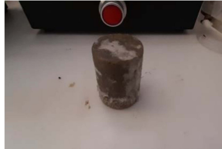
شکل ۲۳ نمونه مغزه پس از سیلاب‌زنی با فیلترات گل حفاری بهبود یافته
