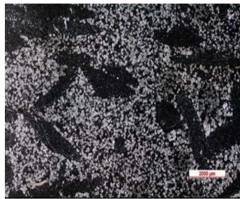
شکل ۱۴ مقطع نازک رخساره MF8 سازند سروک پایینی در عمق ۴۴۷۹/۹۳ m و دولومیتی شدن کامل
