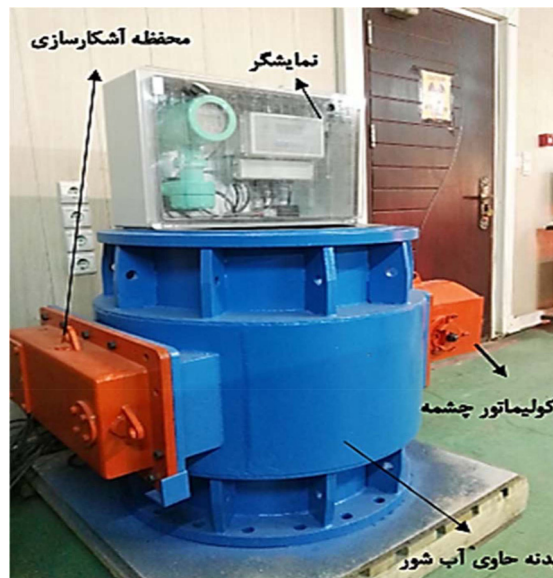
شکل ۸. نمایی از سیستم داده‌گیری تجربی، اندازه‌گیری چگالی محلول آب-نمک موجود در آزمایشگاه. سیستم غلظت‌سنج هسته‌ای مشتمل بر (۱) بدنه حاوی آب شور، (۲) محفظه آشکارسازی، (۳) یکسوساز چشمه، و (۴) جعبه حاوی صفحه نمایشگر.
