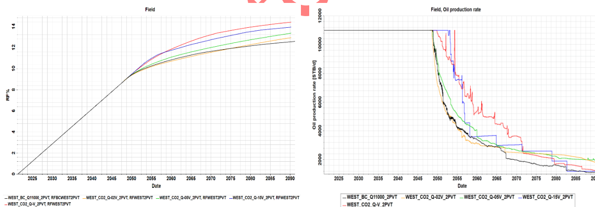
شکل ۲۲- راست: دبی، چپ: درصد بازده تولید نفت در سناریوهای مختلف تزریق گاز دی‌اکسیدکربن برای نسبت‌های تزریق به تولید متفاوت ۱، 0/5 ، 1/5 و 0/2 در مقایسه با تولید طبیعی
