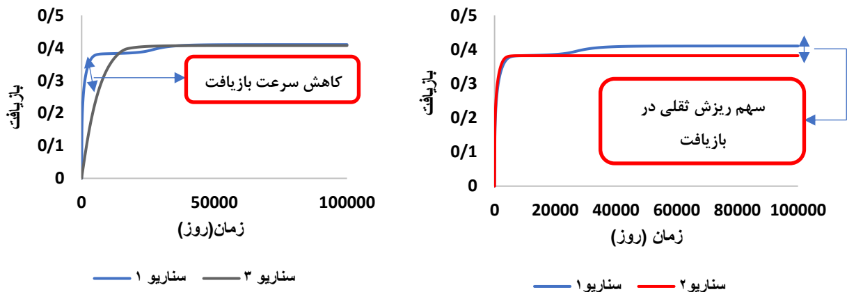
شکل ۸- راست: میزان بازیافت سناریوی ۱ و ۲ و تعیین سهم ریزش ثقلی، چپ: میزان بازیافت سناریوی ۱ و ۳ و تعیین سهم آشام خودبخودی (نیروی مویینه مثبت)
