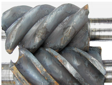
شکل ۴- آثار اکسیداسیون شدید در سطح روتور ها
