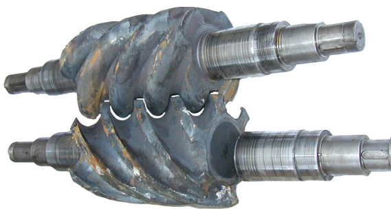
شکل ۱- نحوه قرار گرفتن روتورهای نر و ماده در داخل بدنه کمپرسورهای Screw
