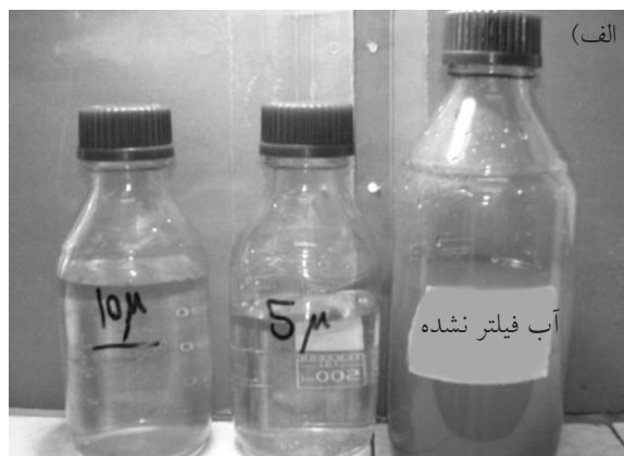
شکل ۱- الف) سه نوع آب مورد استفاده در این مقاله که به ترتیب از راست به چپ، آب فیلتر شده، آب فیلتر شده با صافی 5 \mu و آب فیلتر شده با صافی 10 \mu (ب) فیلترهای استفاده شده و ذرات جدا شده بر روی آنها
