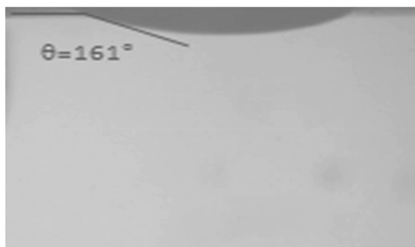
شکل ۳ قطره هپتان قرار داده شده بر سطح سنگ کربناته در محیط آبی بعد از قرار دادن سنگ‌ها در نفت مدل به مدت دو هفته
