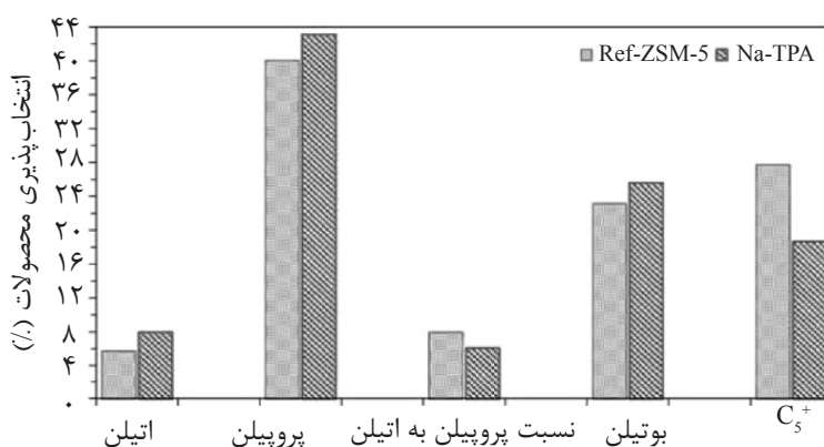
شکل ۷ توزیع محصولات فینلی و هیدروکربنی سنگین در کاتالیست‌های Ref-ZSM-5 و Na-TPA
